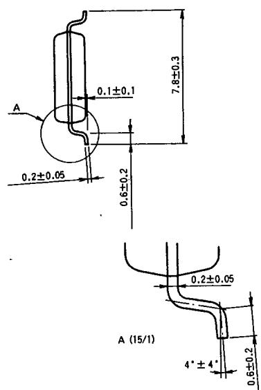
TYPE 16P2N 16PIN MOLDED PLASTIC SOP
