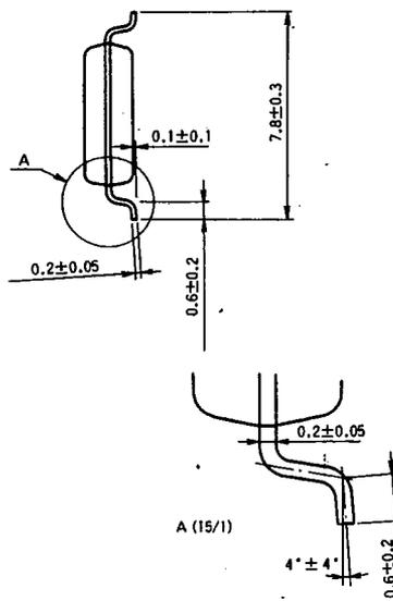
TYPE 20P2N 20PIN MOLDED PLASTIC SOP
