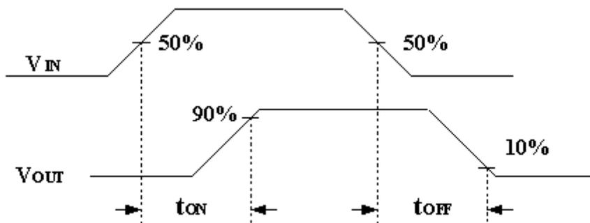
图 2. 开关时间测试图
