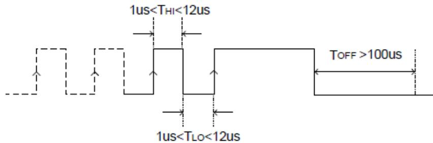
图 6 一线脉冲时序图
