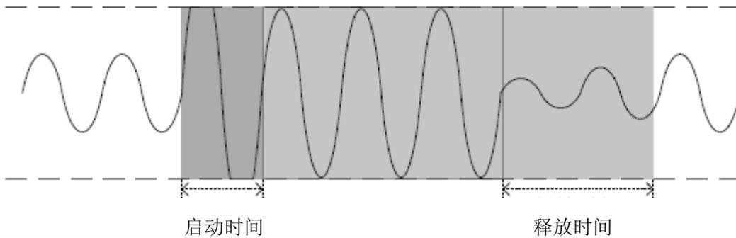
图 4 防失真工作模式下的音频输出信号
