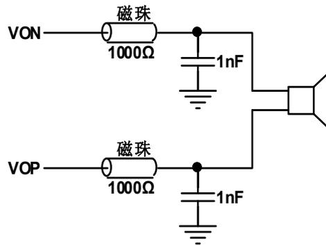
图 8 输出端加磁珠应用图
